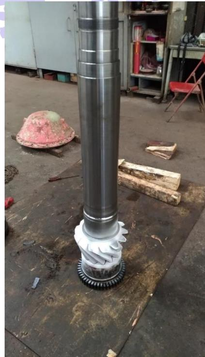
八、 開始回裝作業，直軸、車葉軸組裝，組裝時換新配件，Seal box、Sliding Block、O-Ring、Packing、Bearing 等，新 Bearing 使用加熱油加熱後，再行回裝，直軸、車葉軸換新推力軸承後，量測間隙並記錄。
