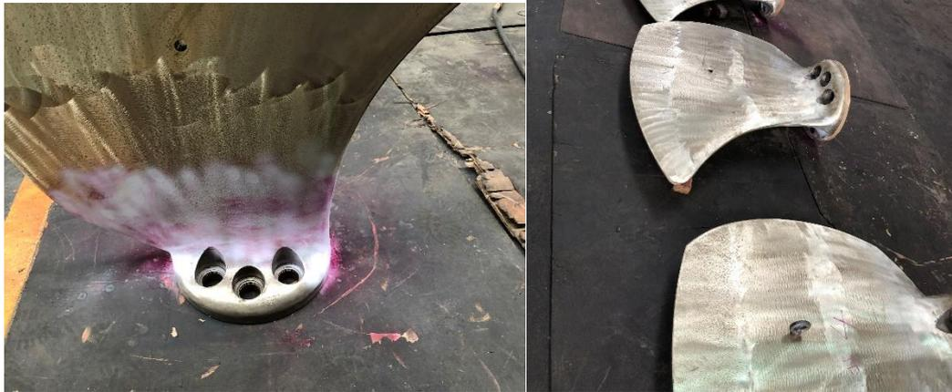
十一、 安排 LC 吊車及吊卡車，並提前通知起重人員吊裝時間，將艙推進器與車葉吊運至塢底開始回裝作業，艙推進器間內油管、聯軸器回裝，固定螺絲鎖緊，固定後請鐵工人員割除吊架，將車葉片使用鍊滑車配合慢慢吊回定位安裝，並使用扭力扳手鎖磅數，回裝完成後，再行量測車葉與 Tunnel 修後間隙並記錄。
