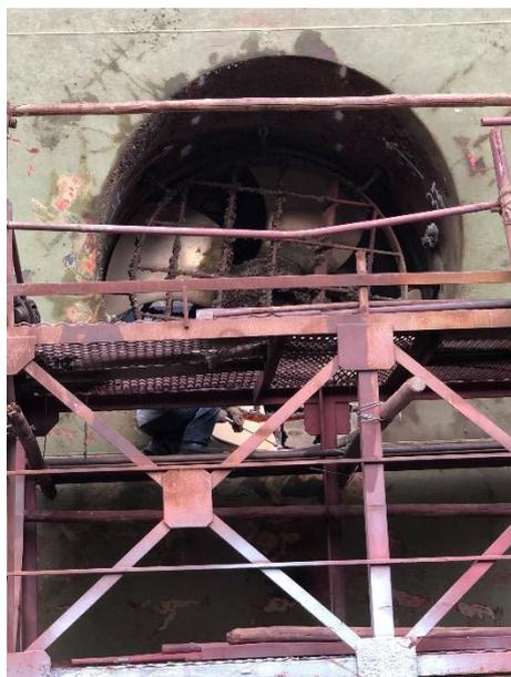
二、艙推進器間裡作業，拆鬆直軸固定螺絲(留兩支或四支位置需在對角)並連接螺桿，拆卸馬達與直軸連接之聯軸器，拆卸其他部分，如液壓油管，彈簧卡榫、螺距指示器裝置……。
