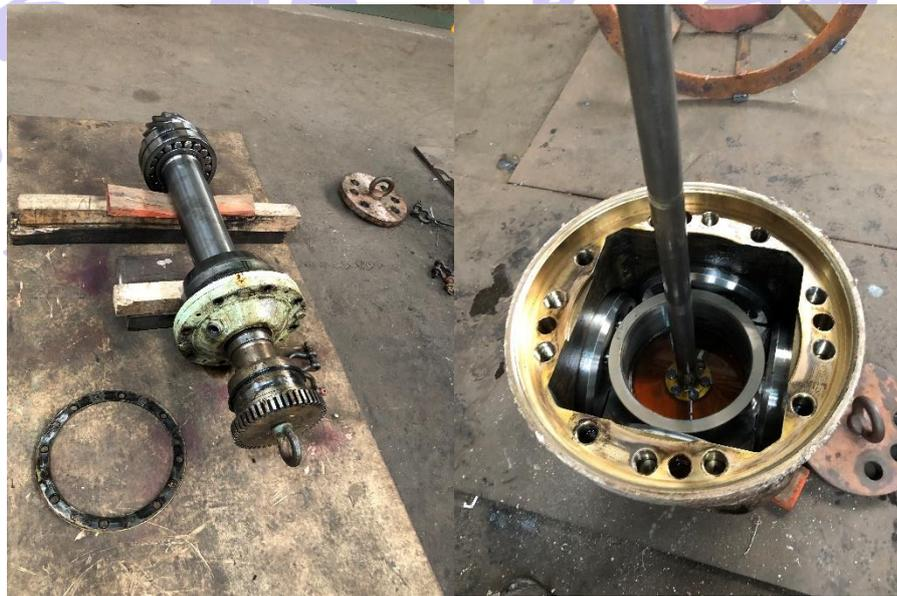
七、 分解後各部件如 Hub、Crosshead Piston、Sliding Block、Bevel
