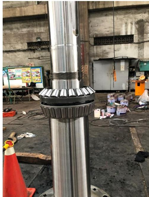
九、直軸、車葉軸回裝至艙推進器本體，組裝完成後，再量測其斜齒輪間隙，直軸上方之聯軸器使用火烤加熱後回裝，Hub 部分包覆保護備便，提前通知鐵工電焊人員協助鉸上艙推進器底部吊架，準備吊回船上進行回裝作業。
