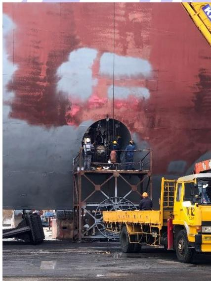
十二、 車葉片回裝完畢後，請船上人員加油，視 maker 或船東要求進行 Flushing 的洗油動作，加滿油後，做試漏測驗。
